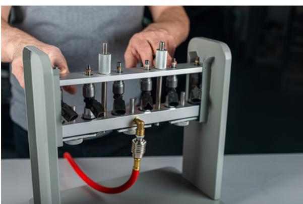
2. Нанесите каплю моторного масла на сопло каждой форсунки и установите давление воздуха 6 Бар.
